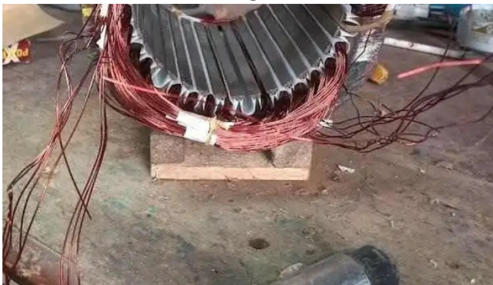
Bobinado de motores taco pozo
